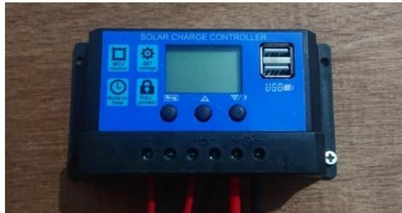
Gambar 2. Solar charge controller (SCC) sebagai pengatur pengisian daya dari panel surya ke aki atau baterai
