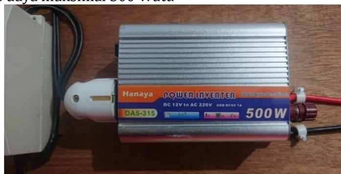
Gambar 4. Inverter Hanaya tipe dengan kapasitas daya maksimal 500 Watt.
