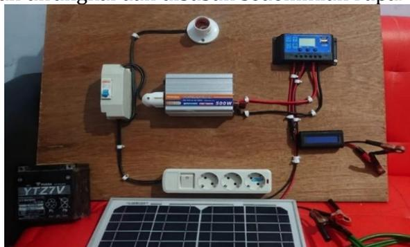
Gambar 6. System instrument kelistrikan panel surya yang telah dirangkai.
