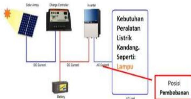
**Gambar 6. Posisi Pembebanan pada Instalasi Sistem Panel Surya**
