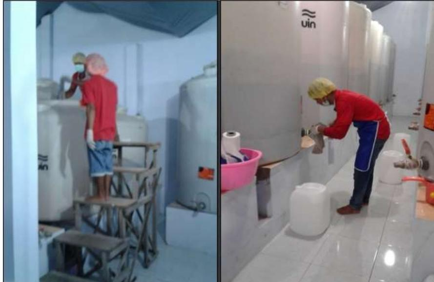
**Gambar 3. Proses Loading ke dalam Tandon dan Tahap Quality Control**
