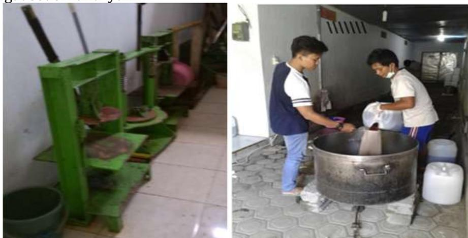
**Gambar 4 Alat Press Limbah Mengkudu Fermentasi dan Proses Pasteurisasi**
