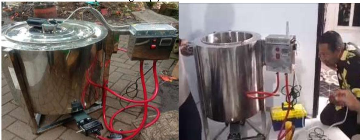
**Gambar 6. Mesin Pasteurisasi Double Jacket yang Diterapkan di UD"ZAM" Jember**
