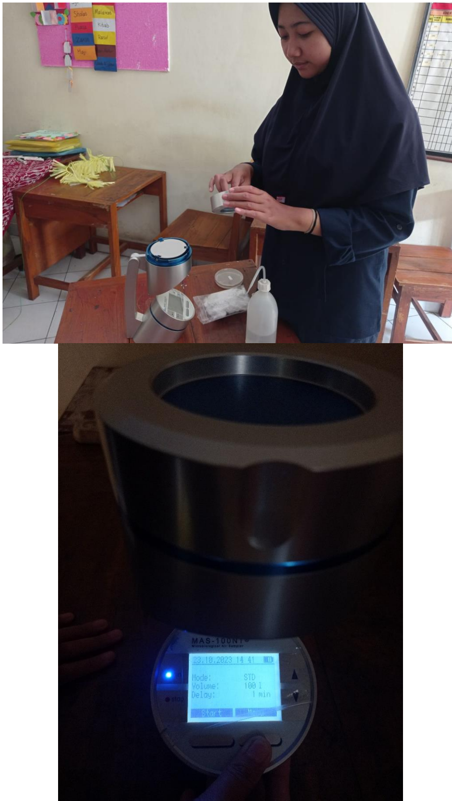
Gambar 8. Kegiatan Pengambilan sampel udara post-test dengan media PCA menggunakan MAS
