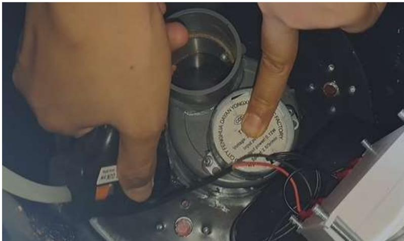
**Gambar 3 Pemasangan Motor Servo**
