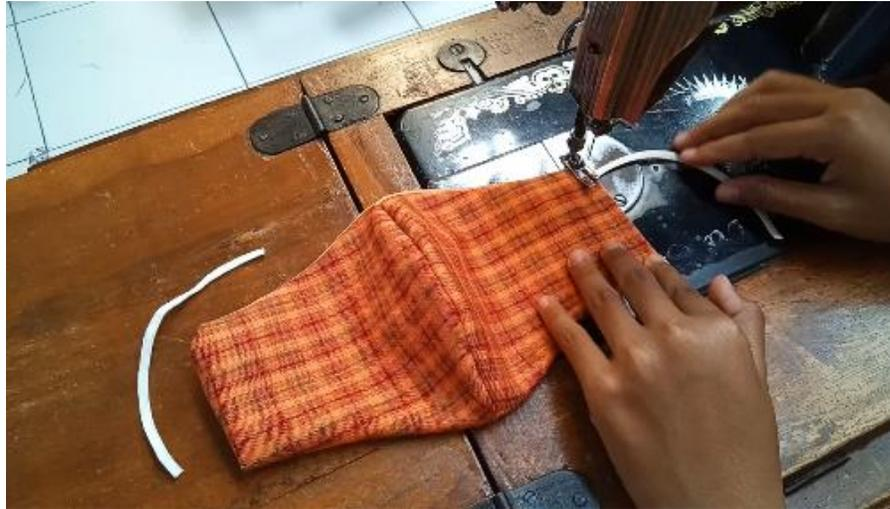
**Gambar 7. Proses pembuatan masker menggunakan mesin jahit**
