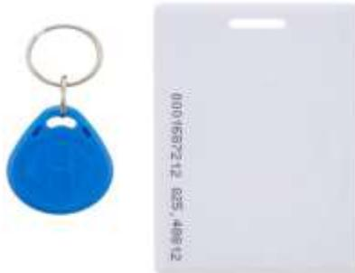
Gambar 1. RFID Tag (Kartu RFID)
