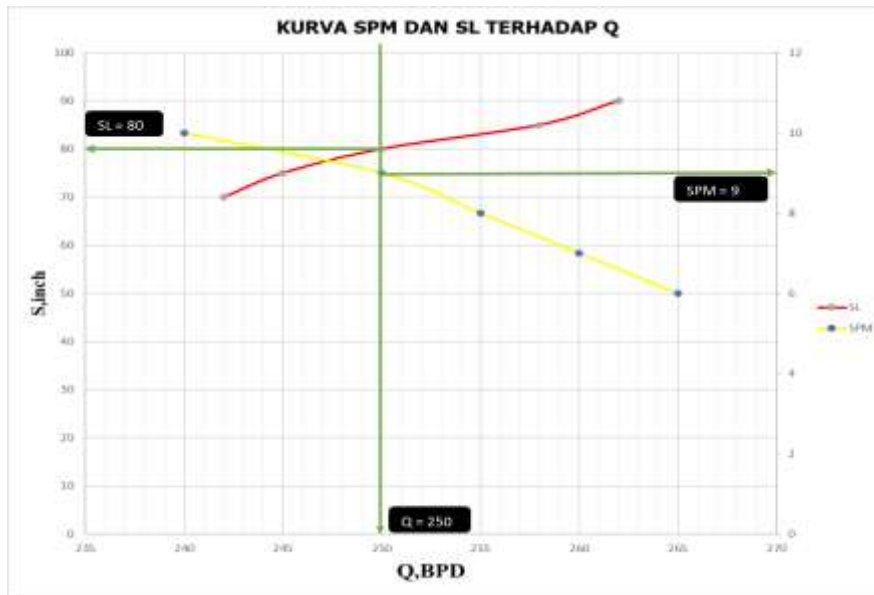
Gambar 4. Kurva Hubungan SPM dan SL Terhadap Q Optimasi HPU
