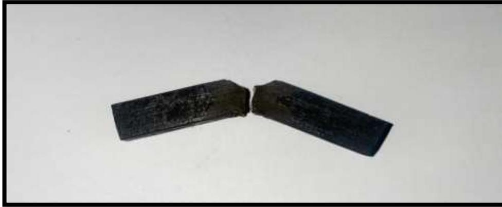
**Gambar 16** Hasil Pengujian Dengan *Quenching* Media Oil
