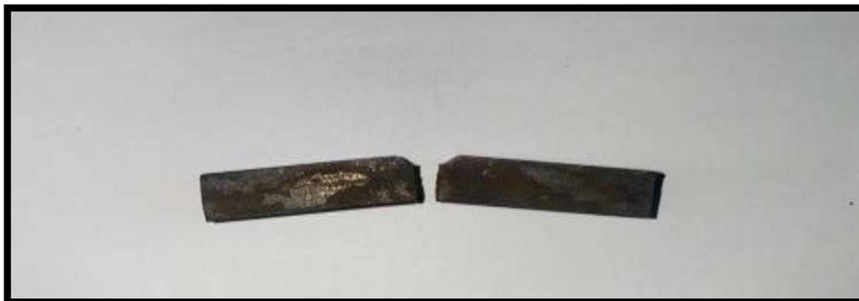
**Gambar 15** Hasil Pengujian Dengan *Quenching* Media Air
