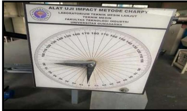
**Gambar 13** Proses Pengujian *Impact Charpy*
