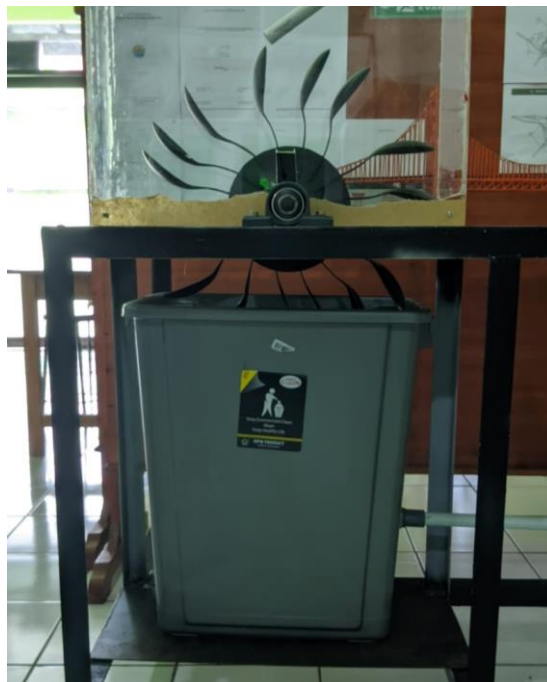
Gambar 4 Bak penampungan air
