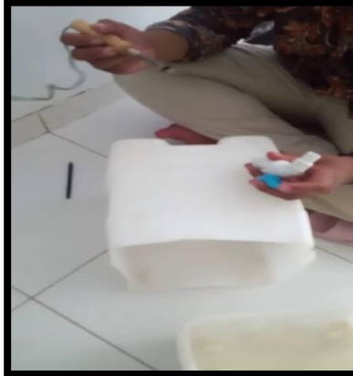
Gambar 4.pemasangan kran ditepi bawah jerigen 1
