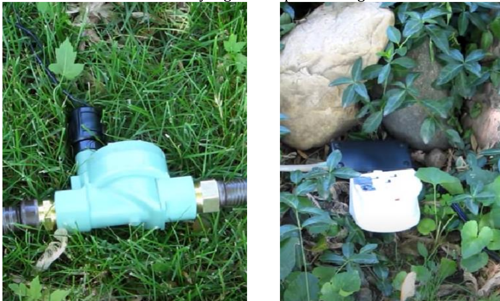
Gambar 4. Peletakan sensor dan valve pada tanah
